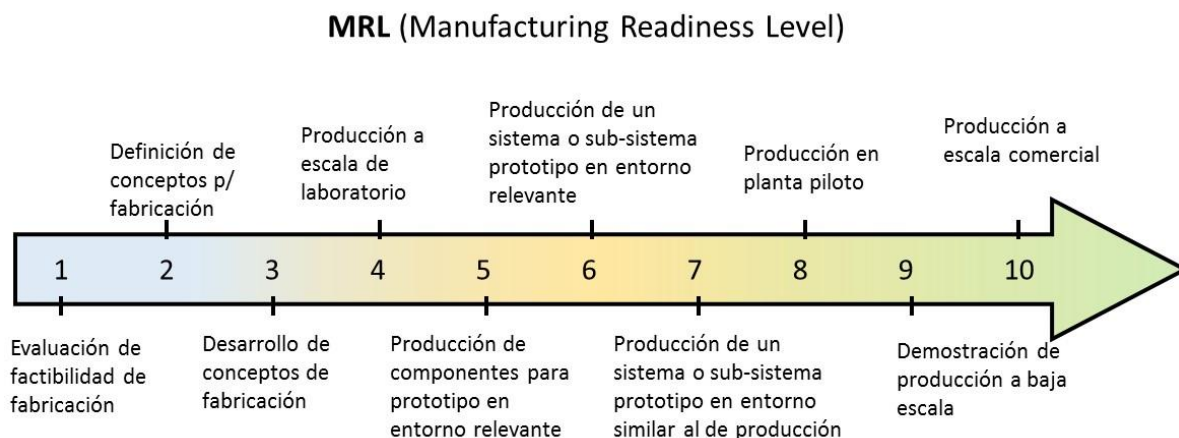
Figura 4. Niveles de madurez de fabricación ( manufacturing readiness level , MRL) que una nueva tecnología debe superar desde la primera evaluación de factibilidad de fabricación hasta la producción a escala comercial.
